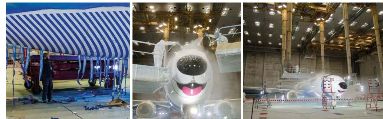
Когда краска высыхает, с корпуса удаляют остатки трафаретов, и самолет покрывают прозрачным лаком, который обеспечивает хорошую аэродинамику и защищает краску и маркировку от ультрафиолетового излучения, агрессивных метеоусловий и воздействия противообледенительной жидкости.
