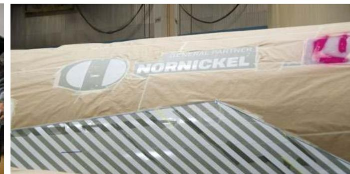
Часть трафаретов готовится на специальных станках – плоттерах. Специалисты тщательно просчитывают все детали на 3D-модели самолета, чтобы при нанесении трафарета рисунок не «повело».
