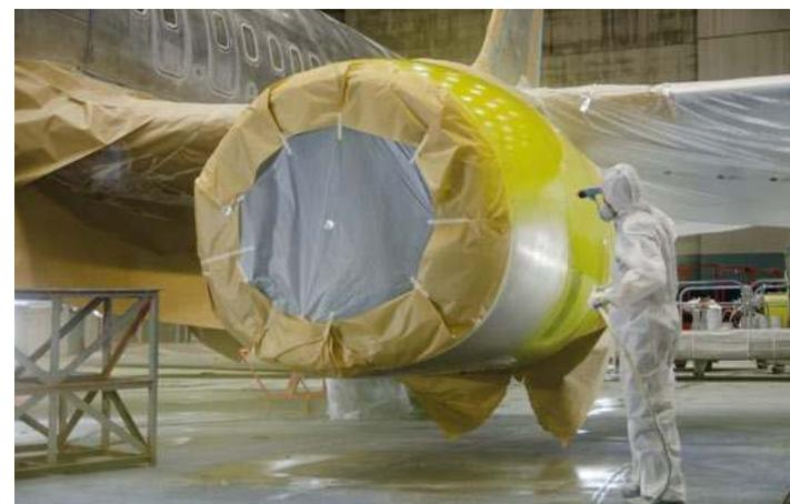
На металлические поверхности наносят два слоя грунта: первичный, «протравливающий», и эпоксидный. Обе грунтовки призваны защитить алюминиевый сплав, из которого сделан самолет, от коррозии и обеспечить лучшее сцепление металла с последующими слоями краски.
