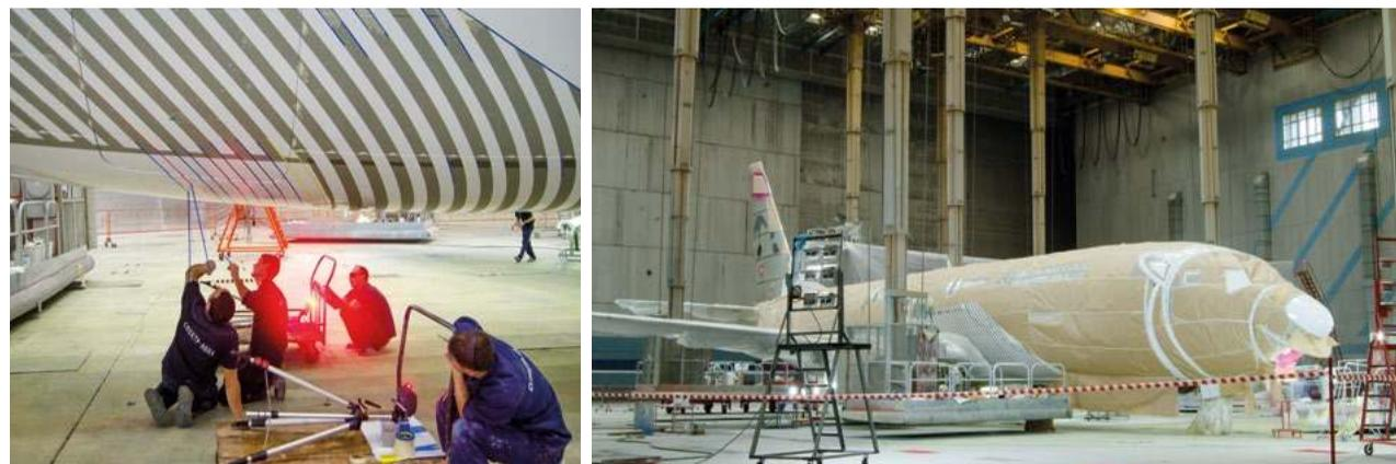
Для ювелирной точности особо сложные трафареты твердой рукой мастера клеят по ровным линиям лазерной разметки.
