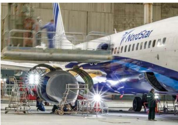
Иллюминатор, шасси, двигатель и другие части самолета укрывают специальной пленкой, которая необходима, чтобы защитить эти части от воздействия специального реагента – «смывки», главная задача которой – убрать слой имеющейся краски.
