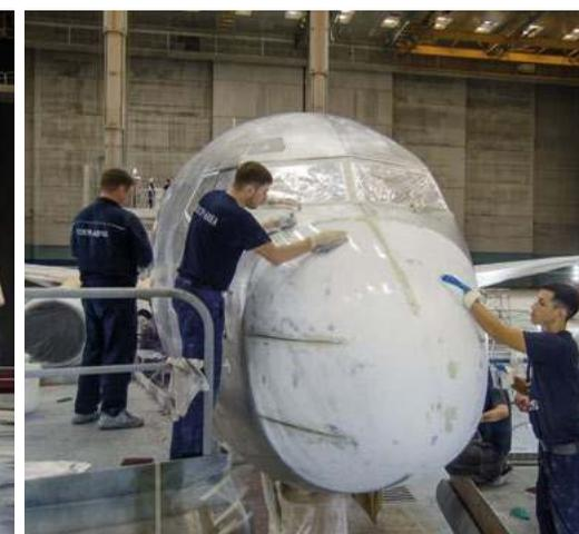
«Голое» воздушное судно еще раз осматривают и готовят к грунтовке. На все швы самолета наносят герметик, а иллюминаторы и другие элементы, не подлежащие покраске, вновь заклеивают.
