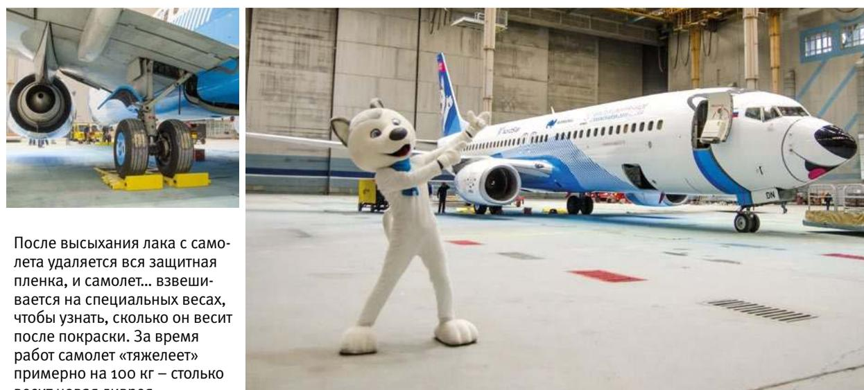
После высыхания лака с самолета удаляется вся защитная пленка, и самолет... взвешивается на специальных весах, чтобы узнать, сколько он весит после покраски. За время работ самолет «тяжелее» примерно на 100 кг – столько весит новая ливрея.
