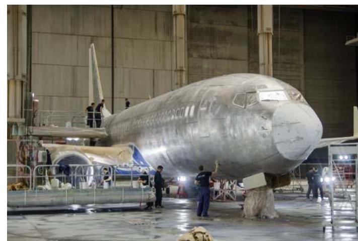
В процессе смывки прежняя краска отслаивается, а самые стойкие кусочки удаляются ручными шлифмашинками вместе с окраской стеклопластиковых элементов, после чего поверхность самолета зачищается до металла и обезжиривается.
