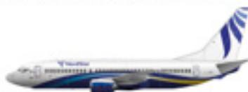
Диаметр фюзеляжа: 3,76 м
