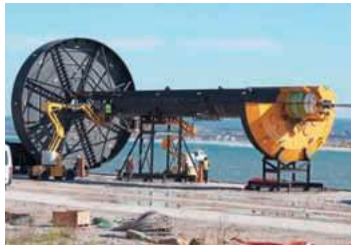
ГЕНЕРАТОР-ПОПЛАВОК ИСПАНСКОЙ КОМПАНИИ IBERDROLA RENOVABLES — ЧАСТЬ БУДУЩЕЙ ФАБРИКИ ПО ПРЕОБРАЗОВАНИЮ ЭНЕРГИИ ВОЛН В ЭЛЕКТРИЧЕСТВО
