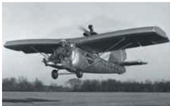
ИСПЫТАНИЯ НАДУВНОГО САМОЛЕТА GOODYEAR
