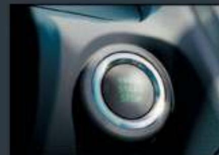
Интеллектуальная система доступа к автомобилю и запуска двигателя нажатием кнопки Smart Entry & Push Start
